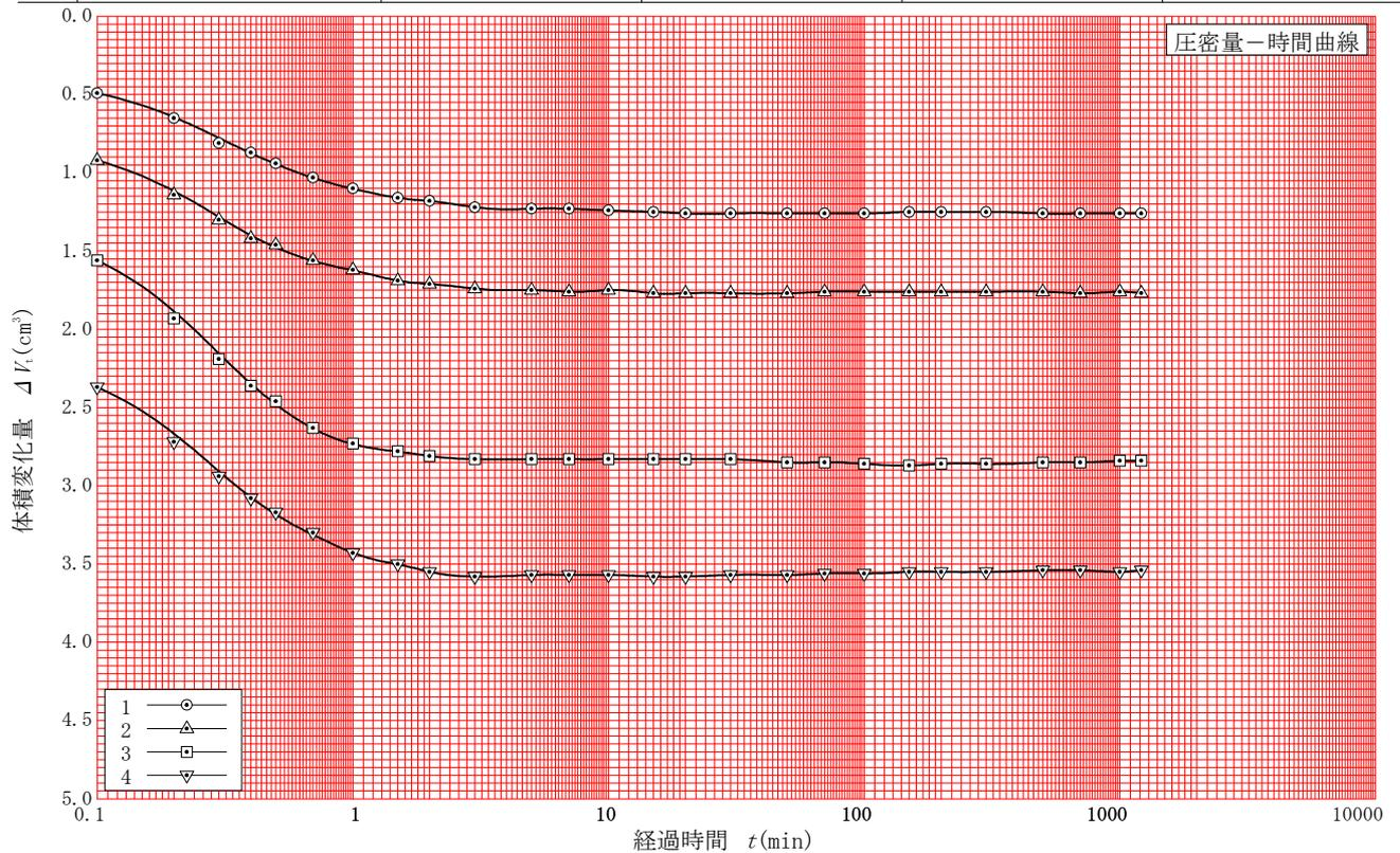
特記事項 最適含水比で、95%pdmax時の密度調整試料
